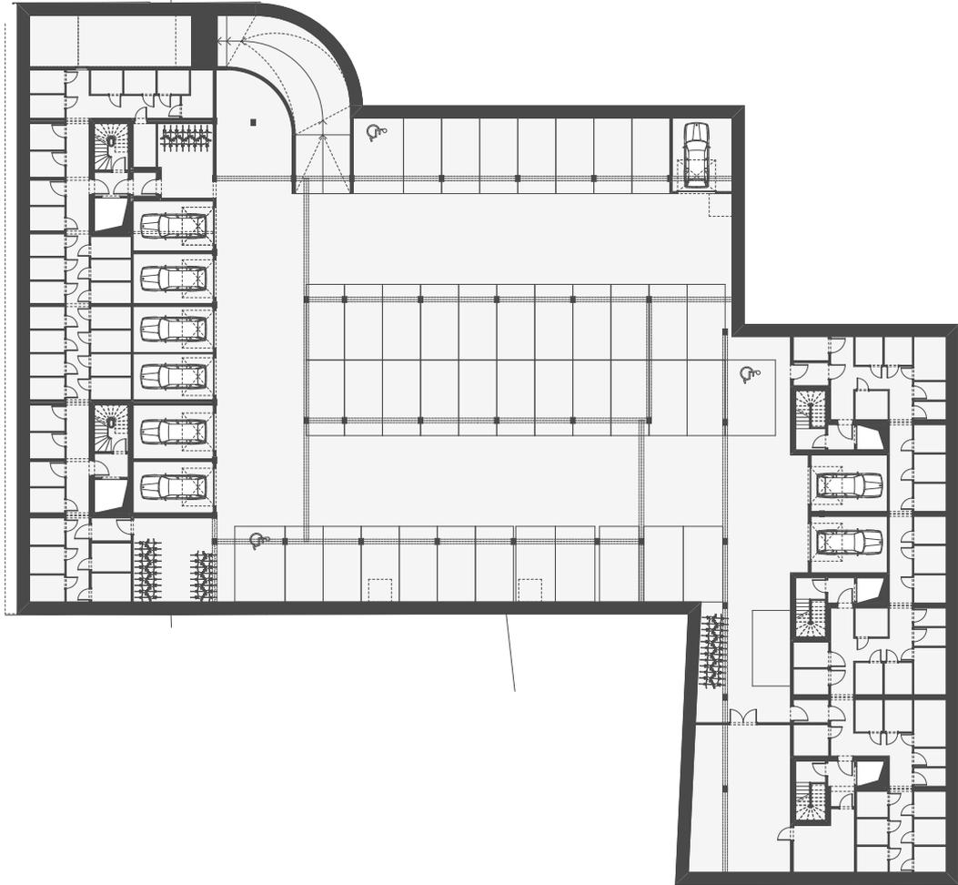
Les différentes voies de circulation du parking et les 5 sas d'entrée seront éclairés par séquences via un système de minuterie, assurant ainsi la sécurité des lieux tout en réduisant l'éclairage pendant la nuit.
